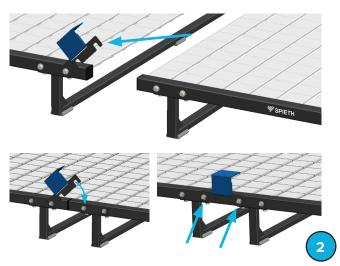
**3.**Beim letzten Element der Bahn steht das Verbindungselement nun über (Abb. 3a). Schrauben Sie das Element komplett ab und fixieren es mit beiden Schrauben am selben Stahlrahmenelement, so dass es nicht mehr übersteht (Abb. 3b).
