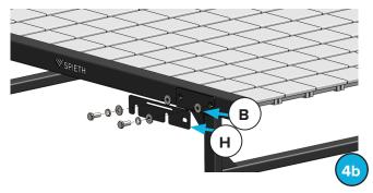
Bringe am ersten Element der Bahn die beiden zusätzlichen losen Verbindungselemente (H) an, damit hier später die Rollmatte ebenfalls fixiert werden kann (Abb. 4a).
